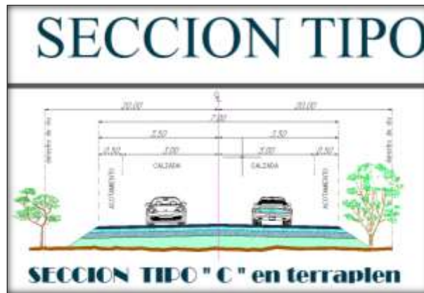
Figura I.4 Sección tipo de la carretera tipo "C" (obtenida de los planos constructivos del proyecto en cuestión).
