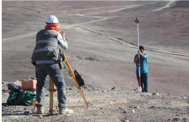
Foto II.9 Ejemplo de levantamiento topográfico.
