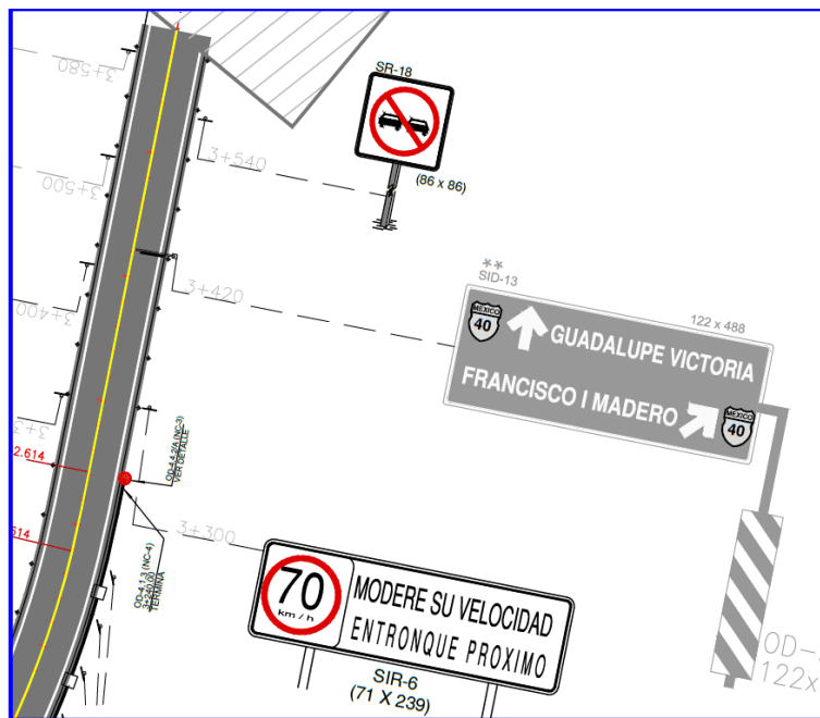
FIGURA II.2.4.3.2.3 DONDE SE MUESTRAN ALGUNAS DE LAS SEÑALES QUE SE INSTALARÁN.
