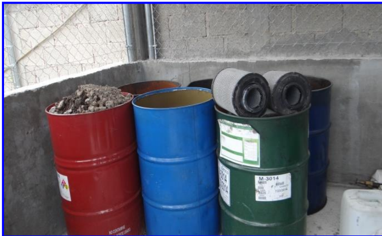
FOTOS VI.1.4.5.6. CONTENEDORES CON RESIDUOS PELIGROSOS DEBIDAMENTE ETIQUETADOS Y CLASIFICADOS
