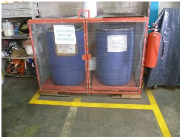
Figura 8. Almacén de residuos peligrosos
