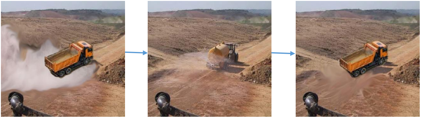
Fig. VII. 4 Disminución en la suspensión de polvo al aplicar riegos con agua tratada. Fuente: Imagen ilustrativa de creación propia con base en imágenes de internet.
