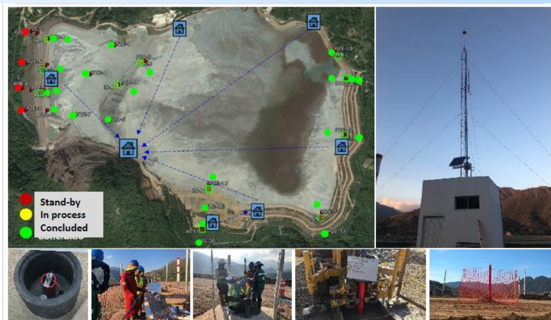
Fig. II.3 Instrumentos de monitoreo para la Presa Guásimas.
