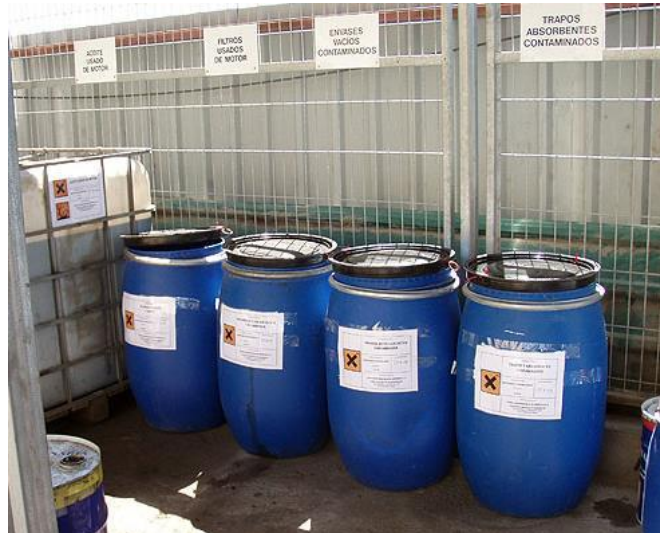
FIGURA 5. Contenedores para residuos peligrosos.
