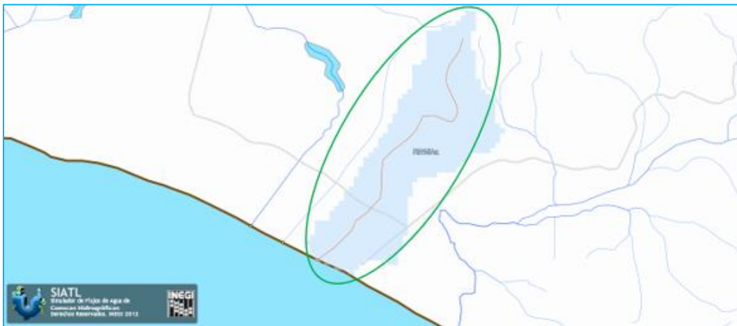
FIGURA 24. Se muestra el escurrimiento intermitente que intercepta con el eje del proyecto justamente en el cadenamiento 7+350 (ovalo color verde).
