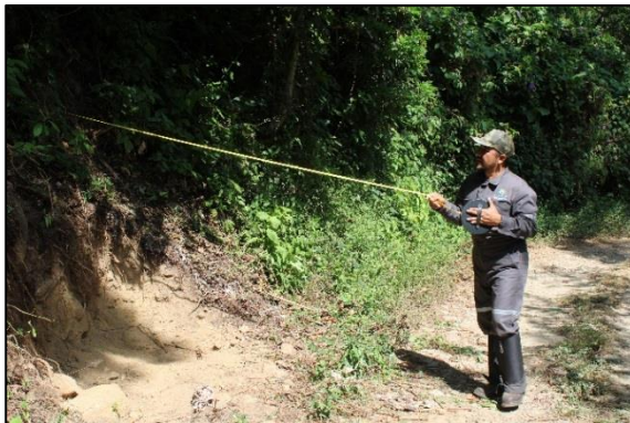
Foto 5. Medición del ancho del camino a la altura del tramo.
