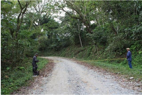
Foto 1. Medición del ancho del camino a la altura del tramo 0+500.
