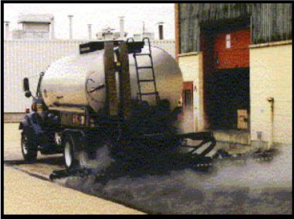
Figura No. II.6. Camión con equipo para aplicar material asfáltico a los caminos.
