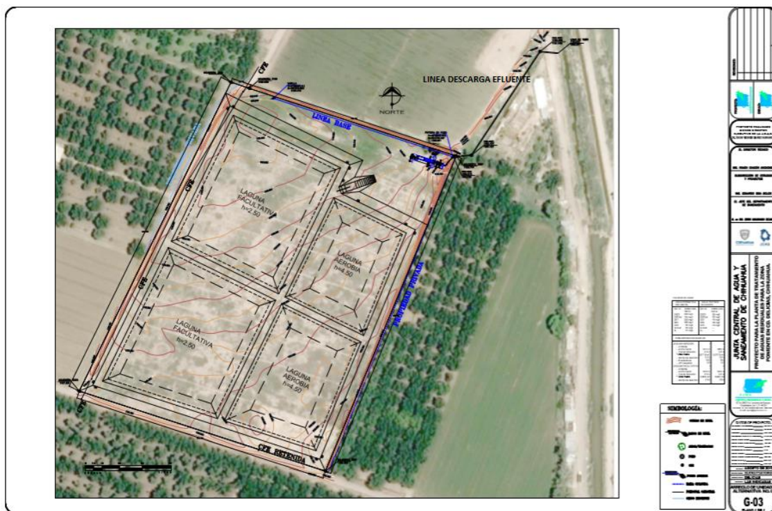
Figura 3.- Plano de ubicación, con rasgos topográficos, obra principal del STARP y obra asociada.
