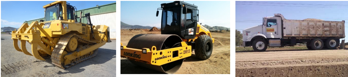
Figura II.13 Imágenes ilustrativas de ripper, cilindro y camión
