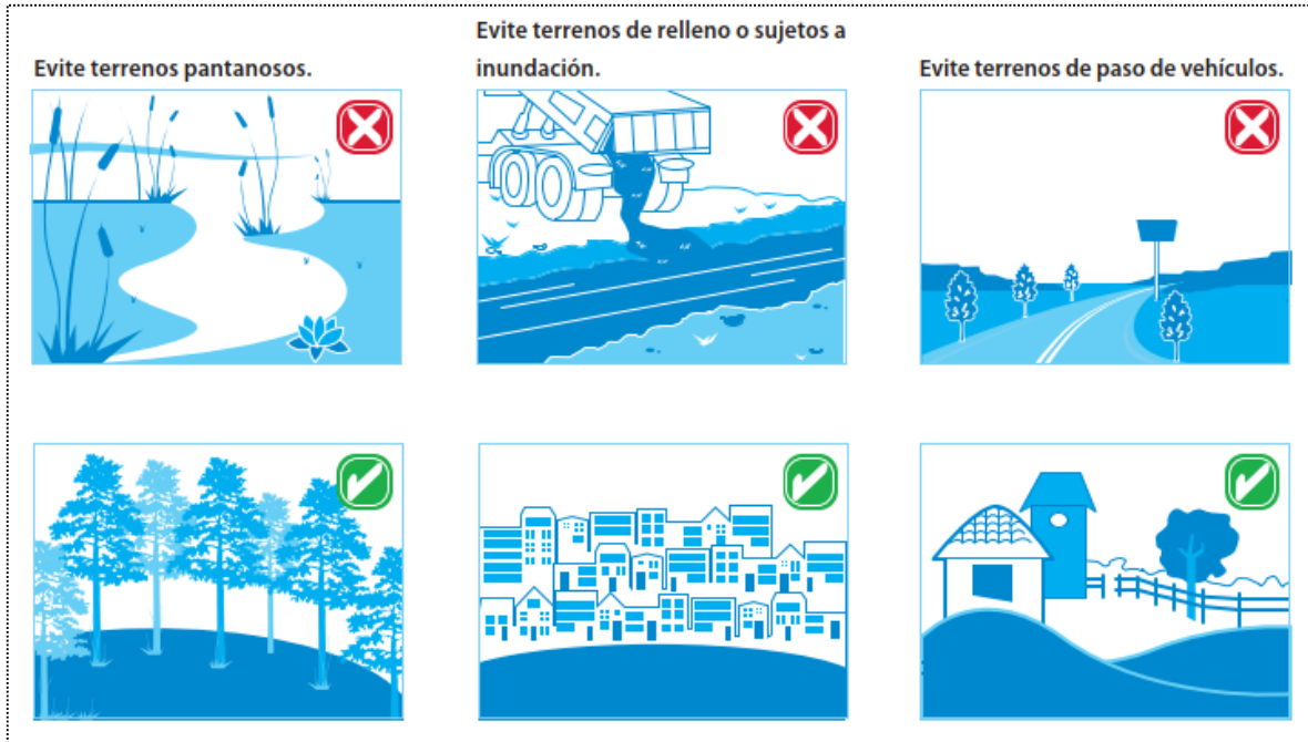
Fig. II.14 Recomendaciones para la localización de biodigestores.
