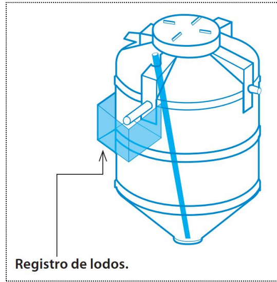
Fig. II.18 Ubicación recomendada para el registro de lodos.
