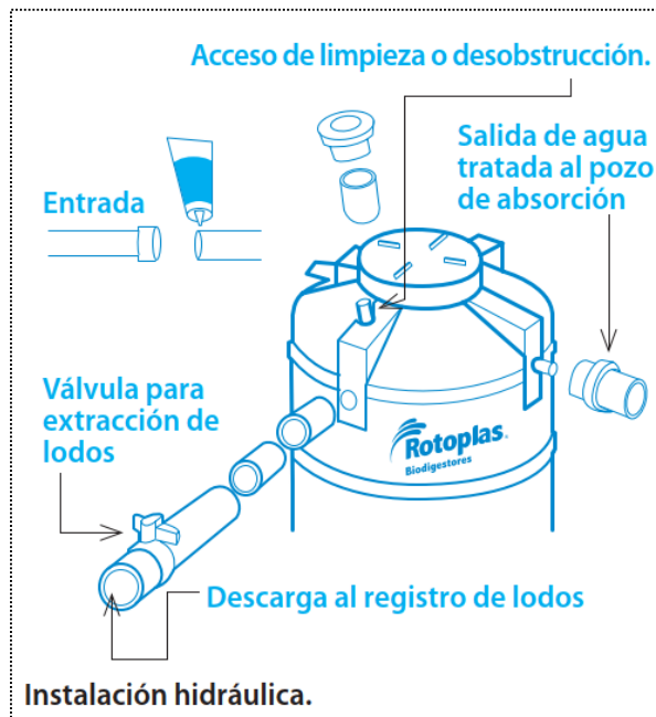
Fig. II.19 Complementos para la instalación hidráulica.
