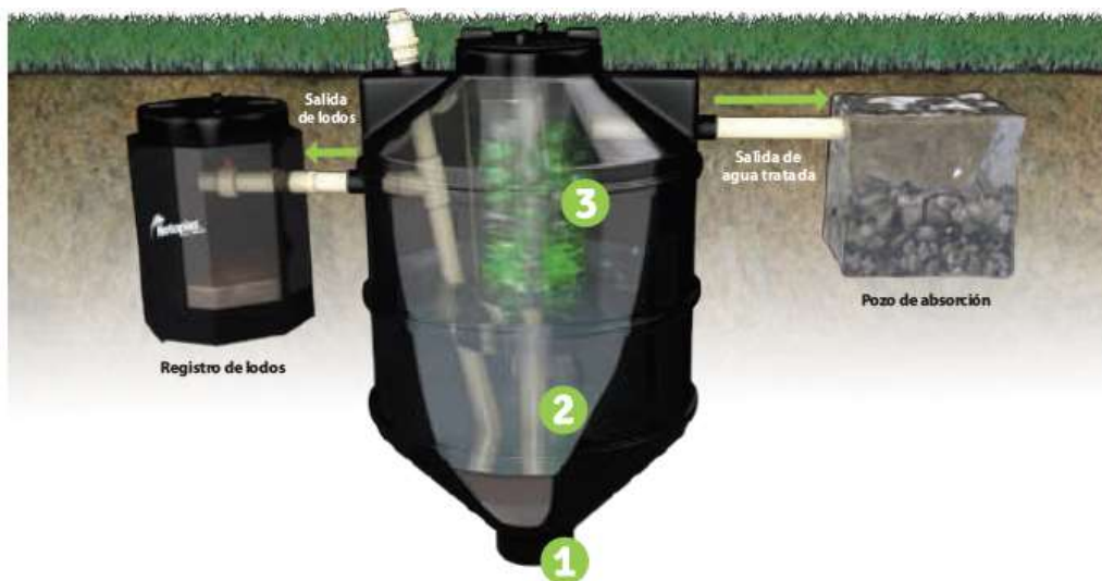
Fig. 10.- Funcionamiento del biodigestor
