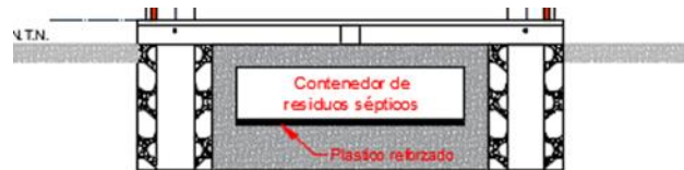
Figura XXX. Contenedor de aguas e instalación sanitaria
