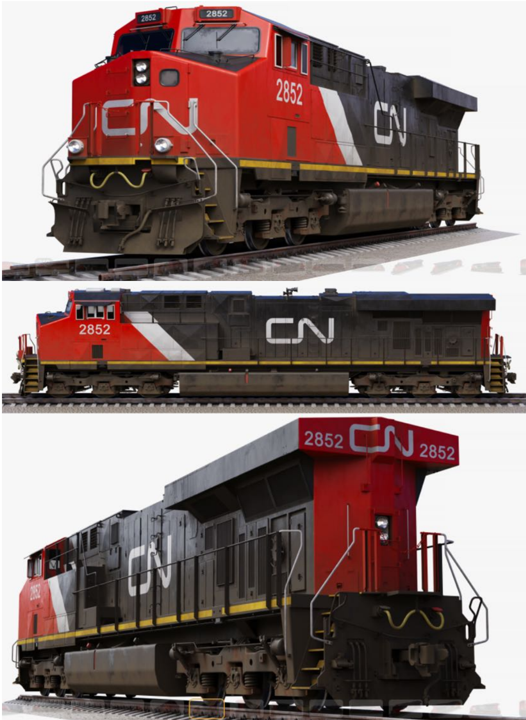
Figura II.69. Imágenes del tipo de locomotora ES44AC
