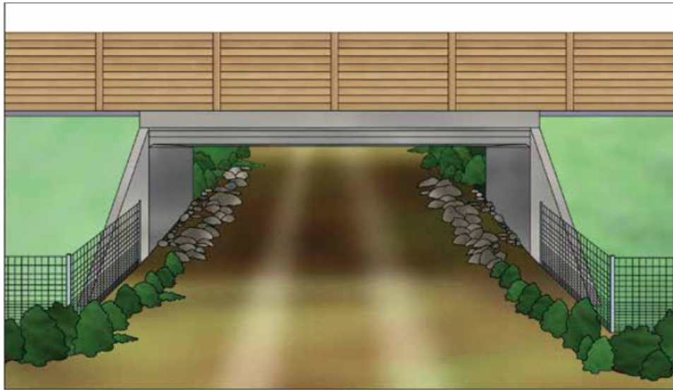
Figura 21. Esquema general de un paso inferior multifuncional ( Fuente: Ministerio de Agricultura, Alimentación y Medio Ambiente, 2015).
