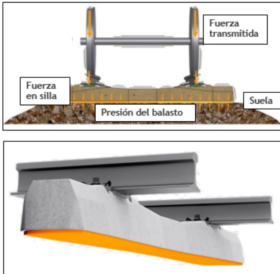
Figura II.16. Suelas bajo durmientes para la atenuación de ruido y vibraciones
