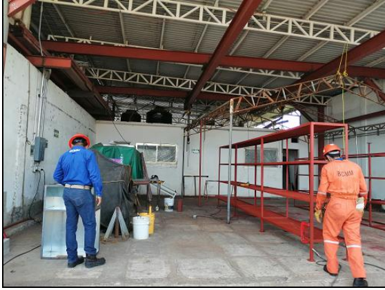
Fig 12 y 13.- Área de corte, soldadura y pintura, se puede apreciar el tipo de estructuras que se realizan como por ejemplo un anaquel para utilizarlo en las mismas instalaciones.
