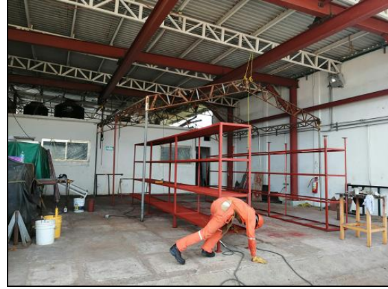
Fig 12 y 13.- Área de corte, soldadura y pintura, se puede apreciar el tipo de estructuras que se realizan como por ejemplo un anaquel para utilizarlo en las mismas instalaciones.
