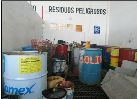
Fig. 23.- Almacén temporal de residuos peligrosos
