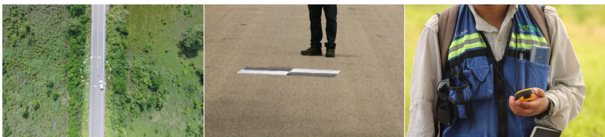
Figura 27. En cada punto de despegue se tomó una coordenada con la ayuda de un GPS y posteriormente se tomó una fotografía aérea perpendicular con el Dron para tener una referencia espacial ubicando una diana de control.
