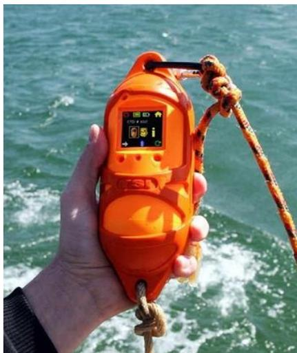
Figura IV. 43. Perfilador de la conductividad, temperatura y profundidad (CTD) marca CastAway – CTD™ © 2010, YSI, Inc. utilizado durante la campaña.
