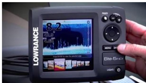
Figura IV. 36. Ecosonda Lowrance Elite-5HDI de alta resolución.
