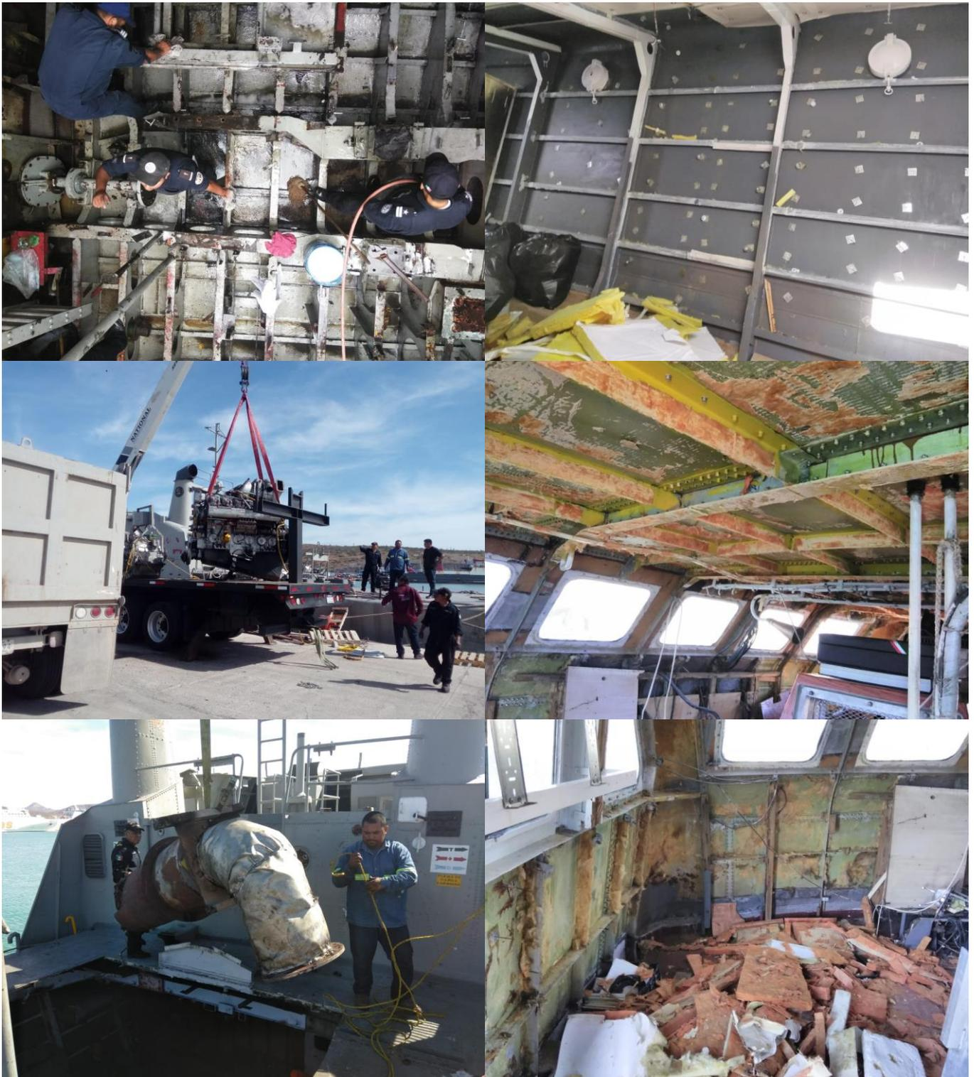
Fig. II.3 Desmantelamiento de la Ex unidad de superficie ARM Juan Antonio de la Fuente (matrícula PC-208).
