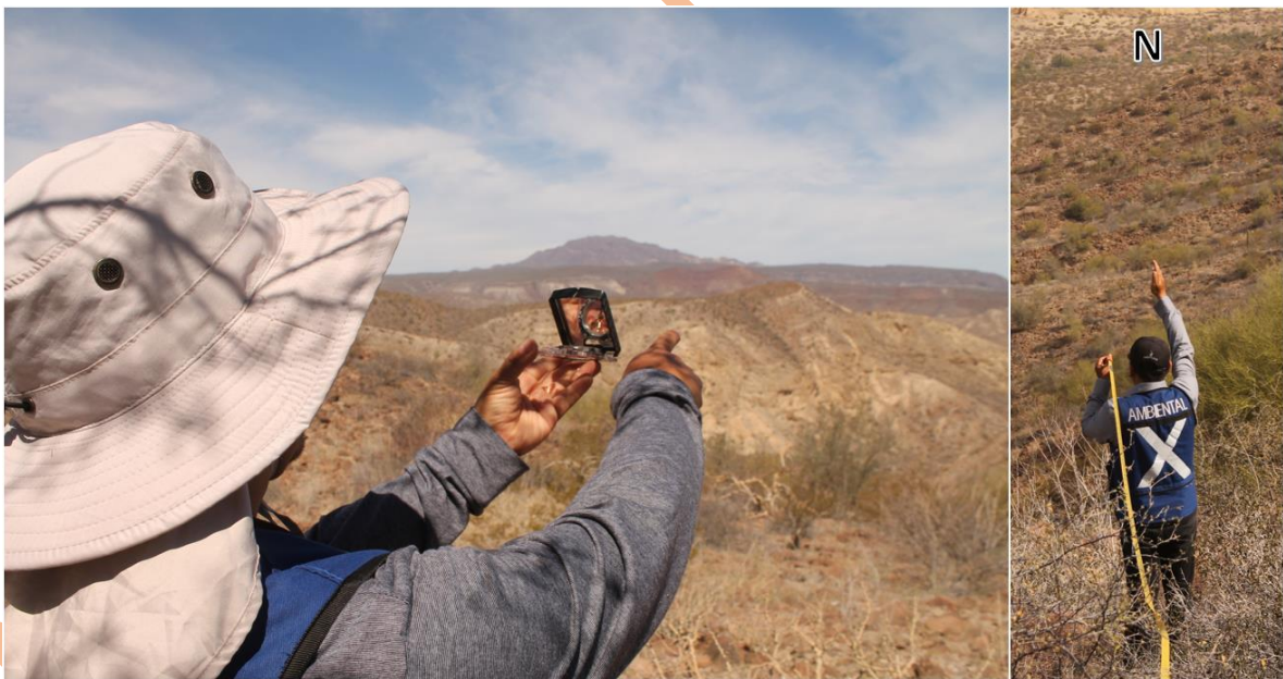
Figura IV. 20 Con la ayuda de una brújula se ubicó el Norte franco partiendo del centro marcado en cada sitio de muestreo y posteriormente con la ayuda de una cinta métrica se delimitó la parcela
