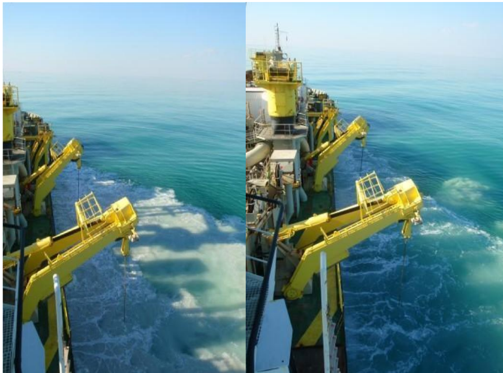
Figura II.39. Fotografía de una draga de succión en marcha, realizando el “overflow” sin la “válvula verde” (izquierda) y draga de succión en marcha realizando el “overflow” con la “válvula verde” instalada (derecha).
