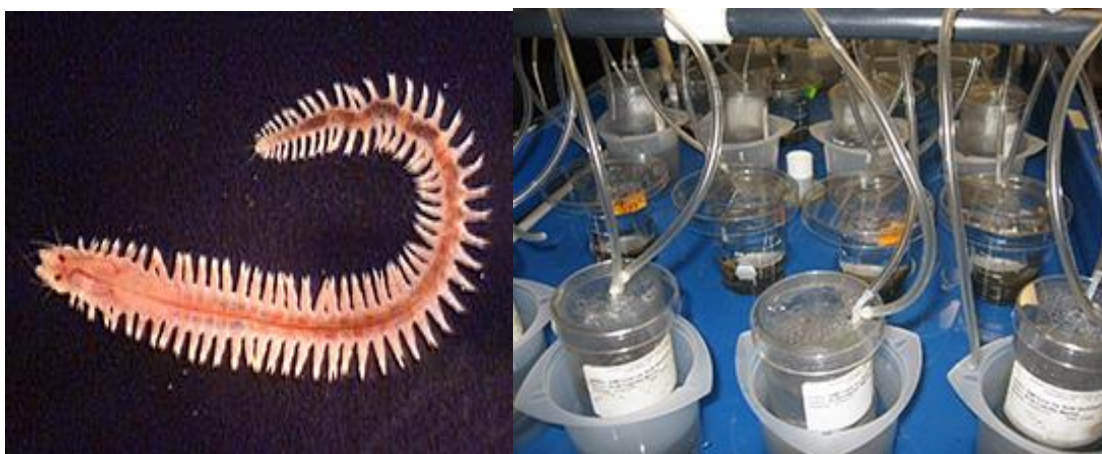
Figura V.207. Bioensayo de toxicidad con el gusano poliqueto Neanthes arenaceodentata .
