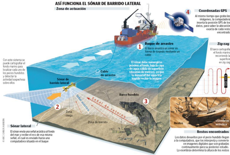
Figura IV. 734. Imagen que muestra a modo de ejemplo el sonar de barrido lateral empleado para la caracterización planctónica y bentónica.
