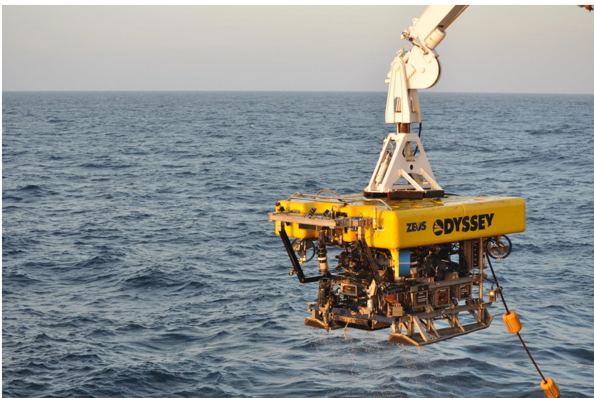
Figura VIII. 12: Vehículo de Operación Remota (ROV por sus siglas en inglés), utilizado para realizar muestreos en la Bahía de Ulloa.
