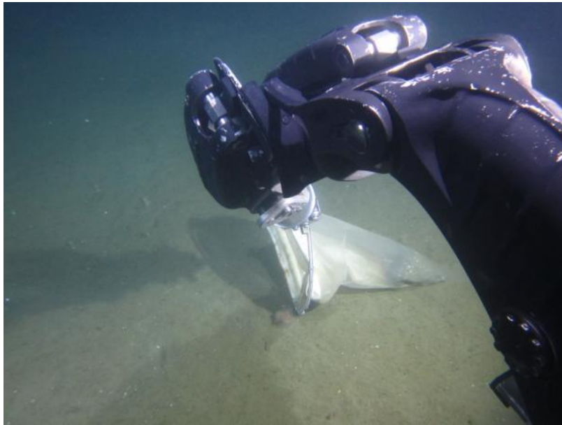
Figura VIII. 8: Obtención de muestras de sedimentos mediante el ROV.
