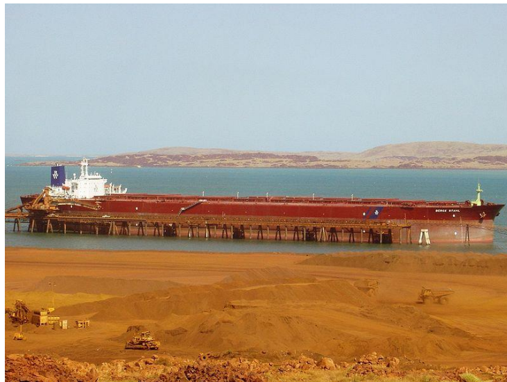
Figura II.58. Handymax – Bulk carriers de 30,000 a 55,000 toneladas, capaces de entrar en la mayoría de los puertos del mundo. Promedio: 40,000 toneladas de capacidad de carga.
