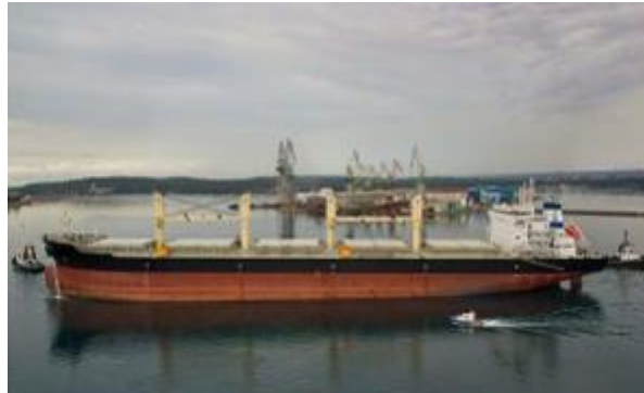
Figura II.58. Handymax – Bulk carriers de 30,000 a 55,000 toneladas, capaces de entrar en la mayoría de los puertos del mundo. Promedio: 40,000 toneladas de capacidad de carga.
