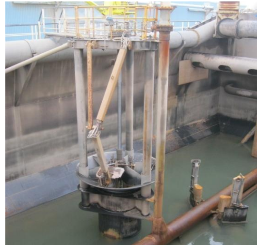
Figura. II.41. Esquematación de un “overflow” típico en la cántara (izquierda) y fotografía de una válvula verde cerrada (derecha).
