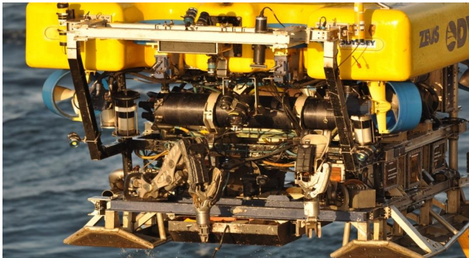
Figura VIII. 17. Vehículo de Operación Remota (ROV por sus siglas en inglés) equipado con dos brazos y diferentes cámaras para realizar monitoreos en la Bahía de Ulloa.
