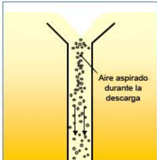
Figura. II.41. Esquematación de un “overflow” típico en la cántara (izquierda) y fotografía de una válvula verde cerrada (derecha).
