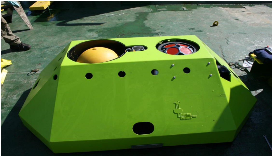
Figura VIII. 19. ADCP utilizado para medir las corrientes en la Bahía de Ulloa.
