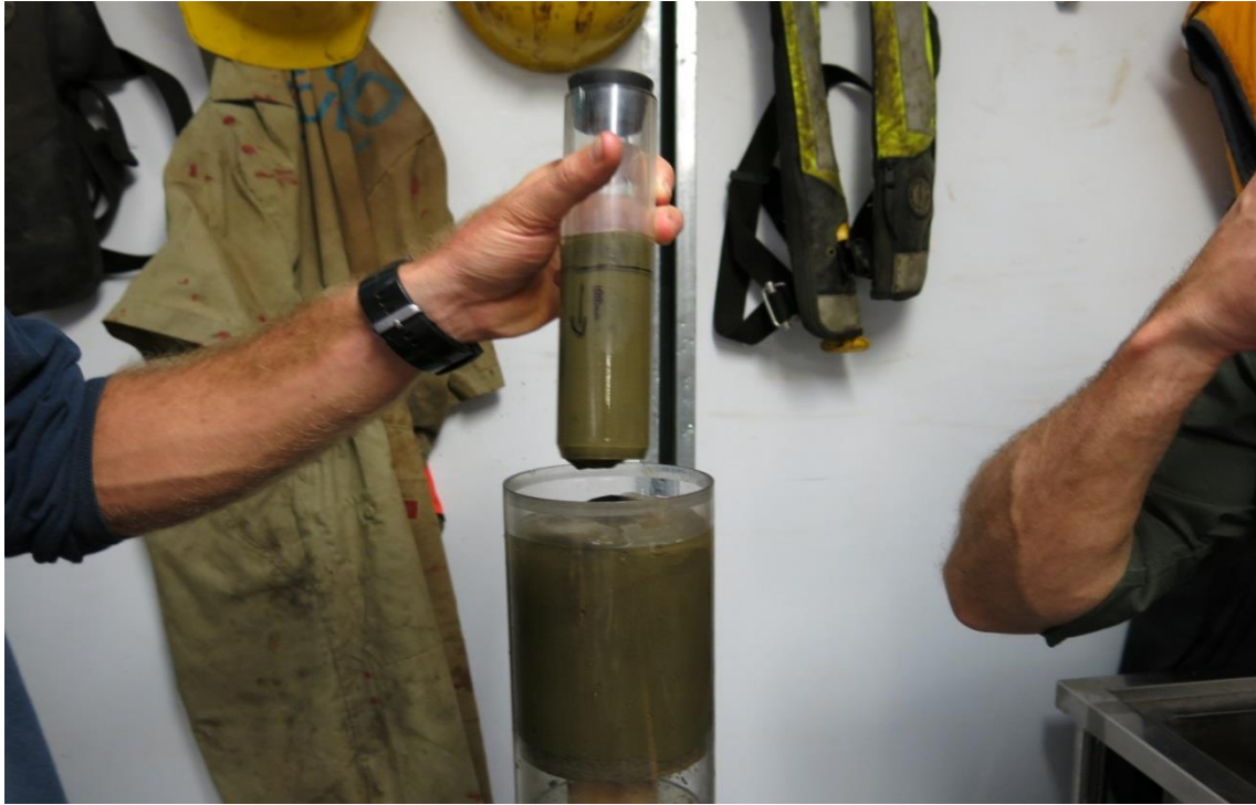
Figura VIII. 21. Muestreo de la columna de sedimentos en el área del proyecto.
