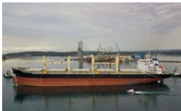
Figura V. 104 Tipo de barco de carga tipo bulk carriers de 30 000 a 55 000 toneladas.
