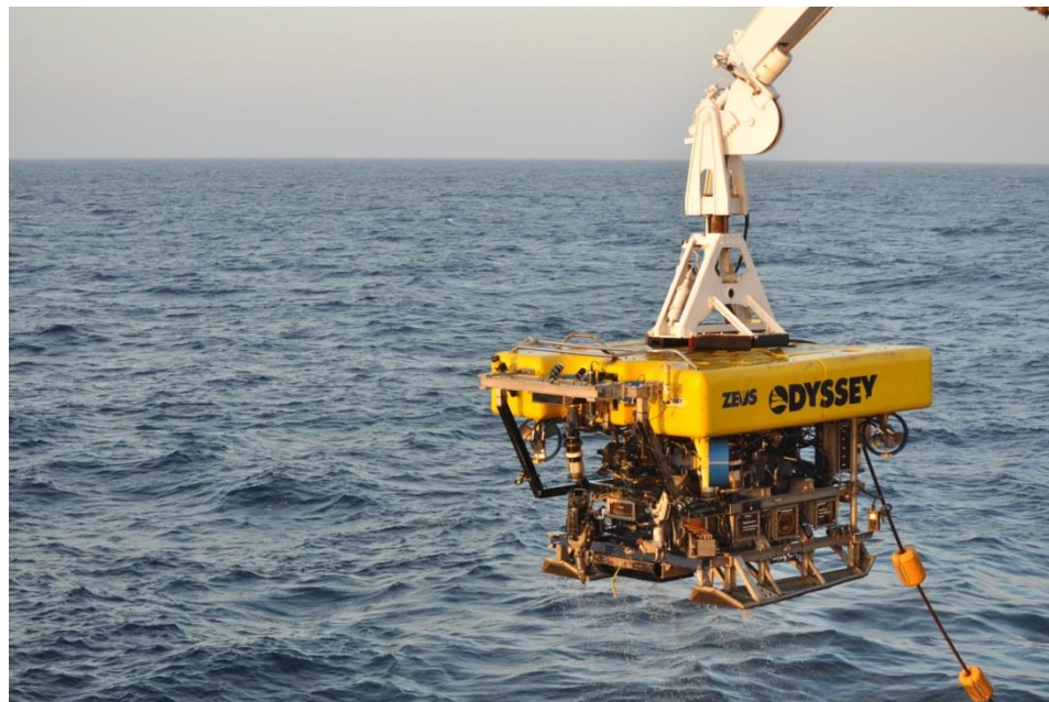
Figura IV. 745. Vehículo de Operación Remota (ROV por sus siglas en inglés), utilizado para realizar muestreos en la Bahía de Ulloa.
