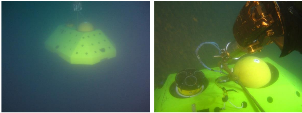
Figura VIII. 14: Colocación de un anclaje de ADCP en el fondo, para medir corrientes y calibrar los modelos numéricos.
