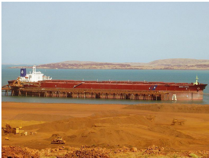
Figura V.15. Tipo de barco de carga tipo bulk carriers de 100 000 a 200 000 toneladas.
