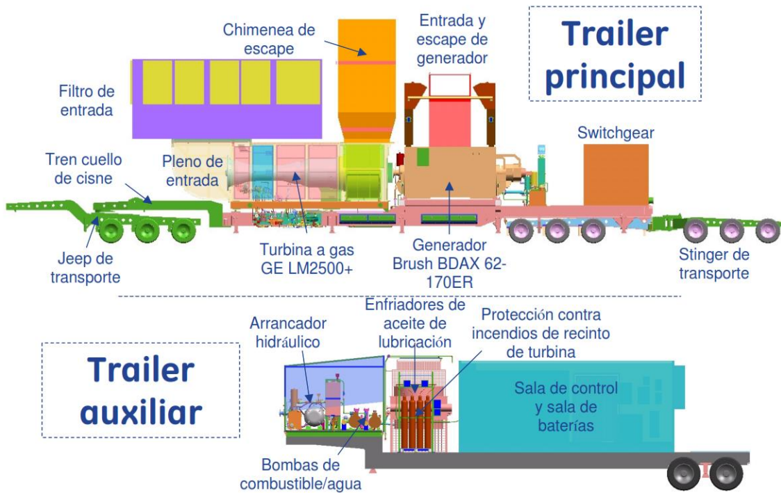
Figura 19: Disposición de los elementos de los Tráileres
