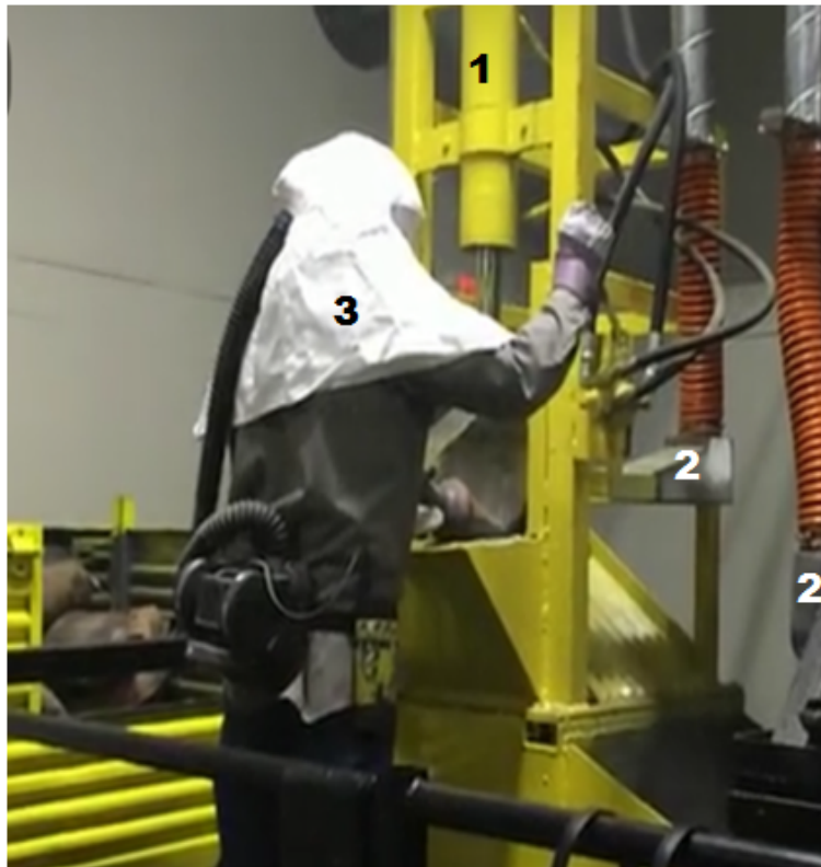
Figura 2.5. Equipo de corte y sistema de recolección de polvos
