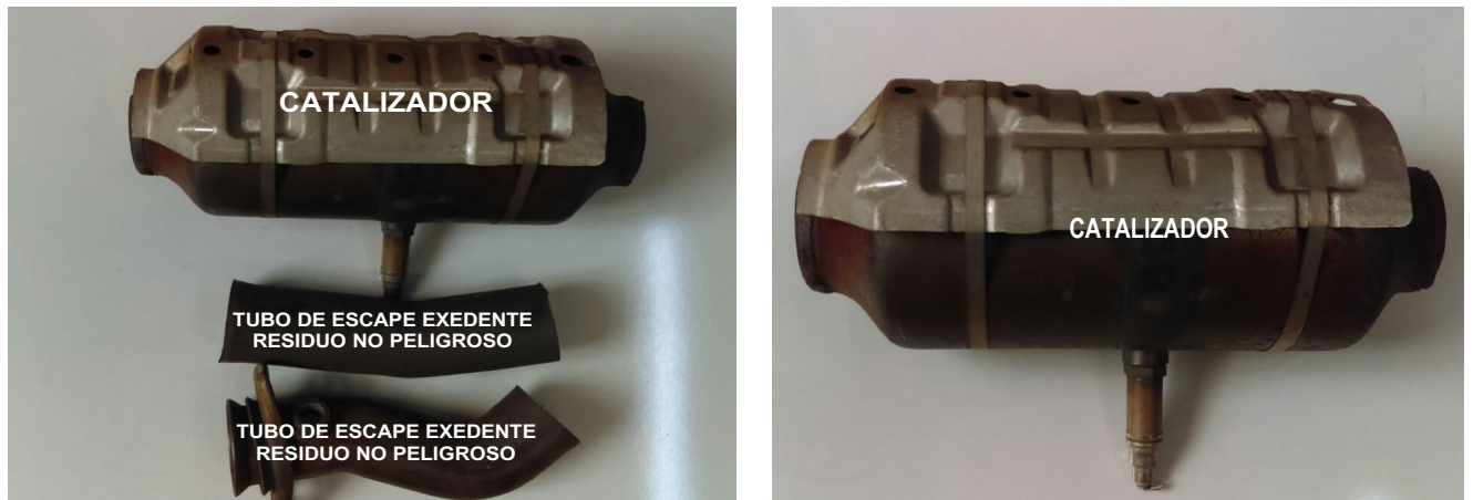
Figura 2.4. Partes que conforman el catalizador
