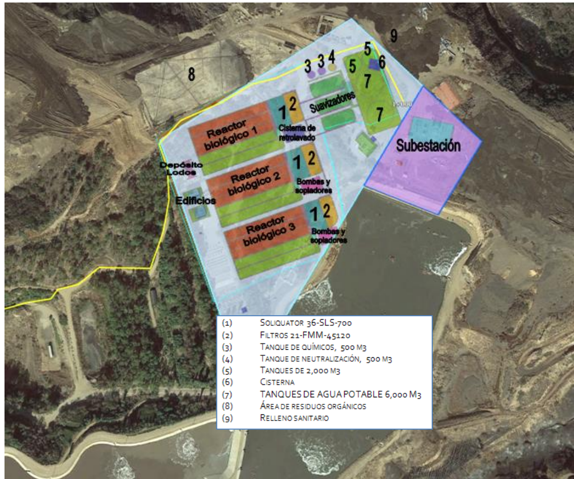
FIGURA II- 7 ÁREAS PRINCIPALES DE LA PTAR DEL PROYECTO AGUA PARA EL VALLE DE GUADALUPE.
