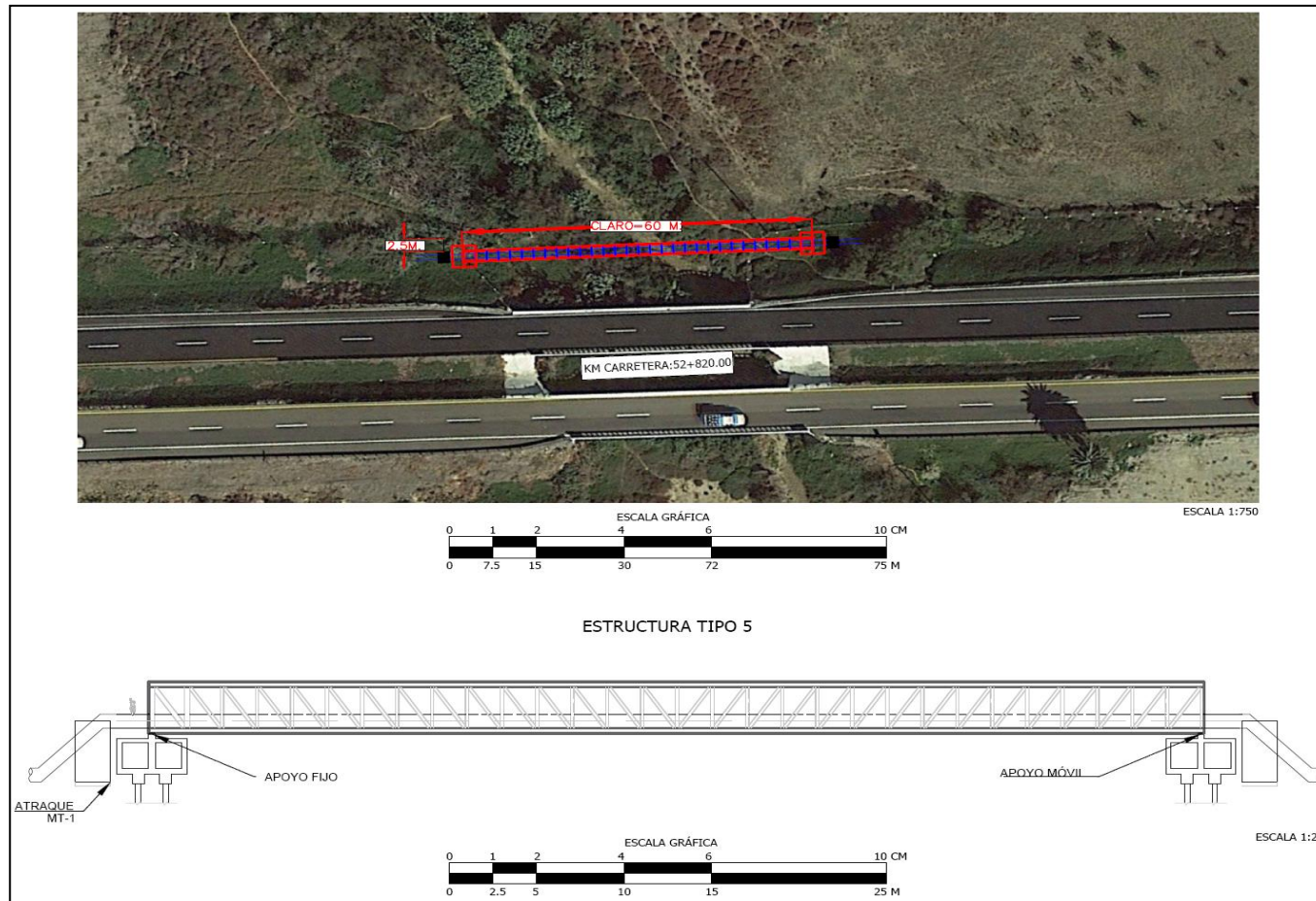
FIGURA II- 56 EJEMPLO DE ESTRUCTURAS RACK, ESTRUCTURA NO. 31 (KM. 52+820.00).
