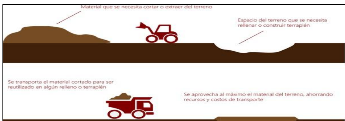
Figura 9. Disposición del material del desmonte
