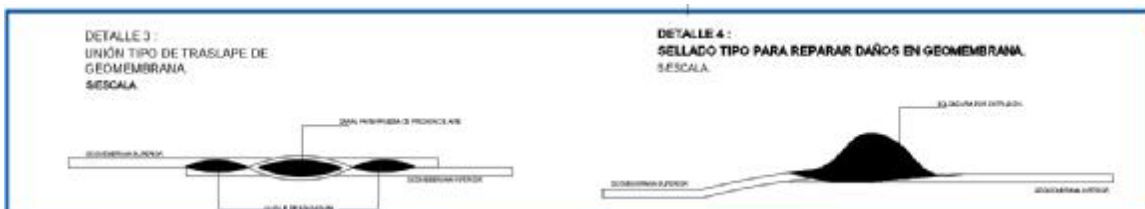
Figura 16. Detalle de la colocación de la geomembrana.
